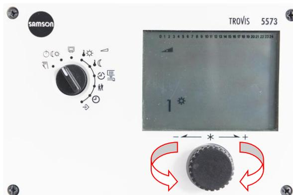
Wählen Sie den Betriebszustand „Automatikbetrieb“ aus, indem Sie den Bedienknopf mit oder gegen den Uhrzeigersinn drehen bis das Symbol für den Automatikbetrieb (Symbol einer Uhr) links neben der „1“ zu sehen ist.
