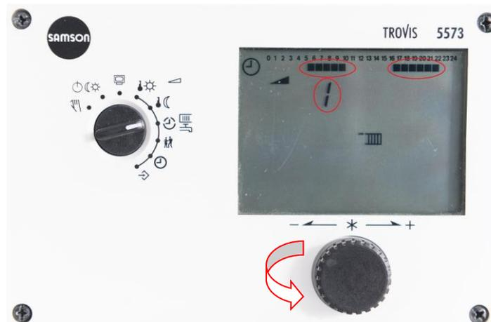
Damit Sie mit den nächsten Wochentagen fortfahren können, müssen Sie den Bedienknopf im Uhrzeigersinn drehen bis der gewünschte Wochentag als Zahl angezeigt wird. Bestätigen Sie die Auswahl des entsprechenden Wochentages durch einmaliges Drücken des Bedienknopfs. Fahren Sie analog zur beschriebenen Vorgehensweise für den Wochentag Montag für die restlichen Wochentage fort.
